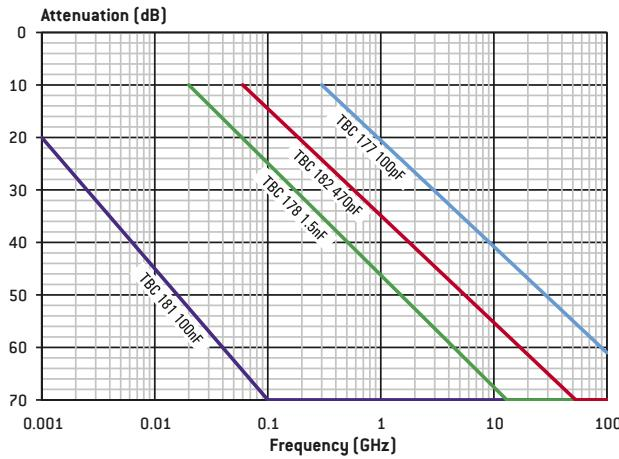
X7R: TYPICAL ATTENUATION CURVE VERSUS FREQUENCY
